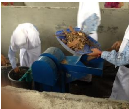
(a) Pencacahan daun-daun kering. (b) Pencampuran daun, tanah, dan EM4 (c) Penempatan bahan kompos dalam reaktor/bak
