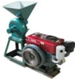
Gambar 1. Disk mill, mesin penepung cangkang kerang
