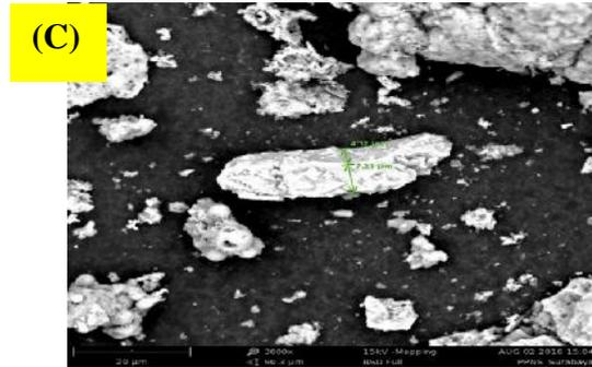
**Gambar 2.** SEM Abu Dasar yang Telah Mengalami *Electroless Plating* dengan Mg pada Suhu Oksidasi (a) 100°C (b) 200°C (c) 300°C.
